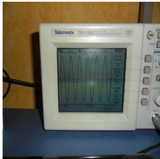
Figura 11 Imagen de la estabilización de la corriente con el arrancador suave
