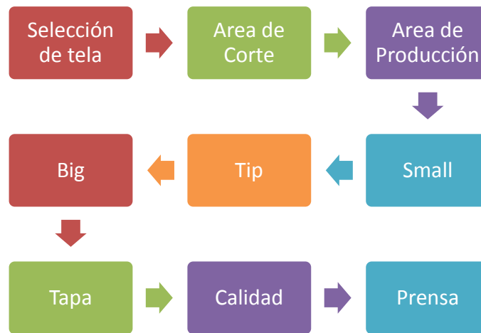
Figura 1. Proceso de fabricación de sacos de Polipropileno
